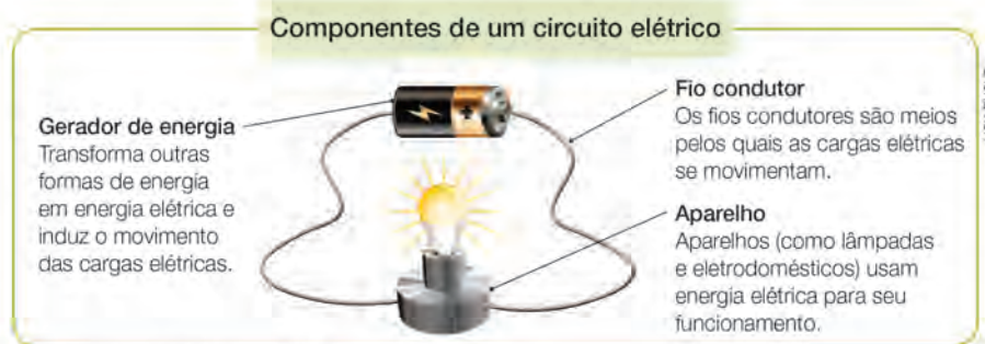
Componentes básicos de um circuito elétrico.
