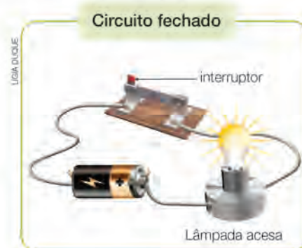
A corrente elétrica só percorre um circuito se ele estiver todo conectado.
