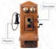
Os primeiros telefones eram pesados e ficavam fixados na parede. Faziam-se com uma peça chamada transmissor e outra se por outra, chamada receptor. Era necessário apoiar uma manivela para chamar a telefonista, que controlava a ligação. Na foto, telefone de 1880.
