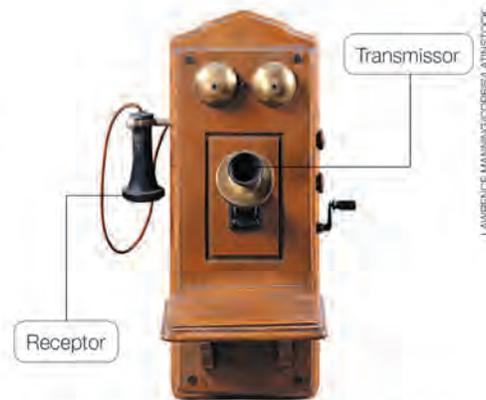
Os primeiros telefones eram pesados e ficavam fixados na parede. Falava-se por uma peça chamada transmissor e ouvia-se por outra, chamada receptor. Era necessário acionar uma manivela para chamar a telefonista, que completava a ligação. Na foto, telefone de 1880.
